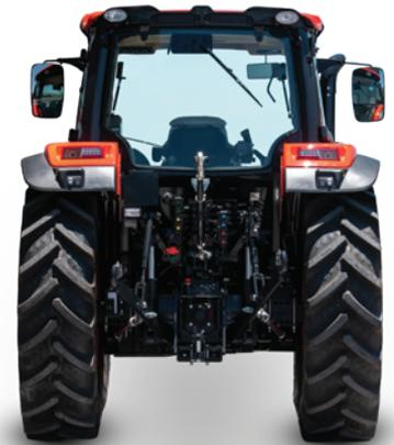
La toma de fuerza trasera, el enganche de tres puntos, las válvulas auxiliares y puerto load sensing pueden acoplar una gran variedad de implementos y accesorios.
