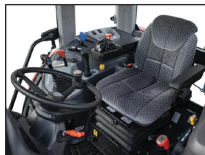
El diseño ergonómico y el asiento con suspensión de aire ajustable permite que el operador viaje cómodamente sin importar cuál sea la tarea.
